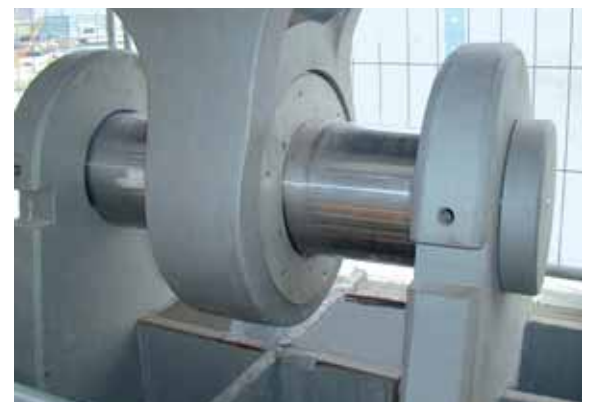
ELGES 的质量堪受检验：交货的轴承系统由支架/轴颈和肘式轴承组成，一概采取特殊规格 - 表面施用 Elgoglide® 技术涂层处理。
