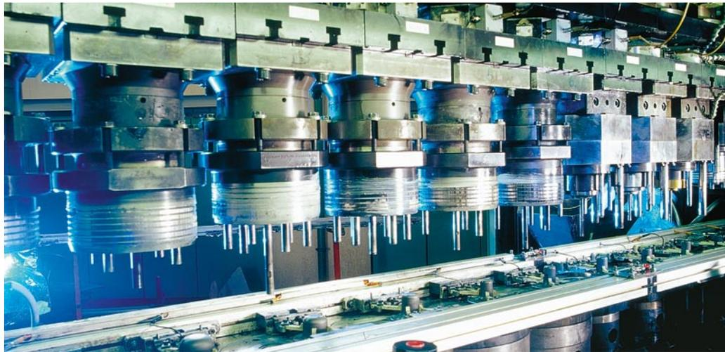
各种各样的模压工艺被充分发展，深冲压技术保证了成型技术生产的轴承组件的经济性。
