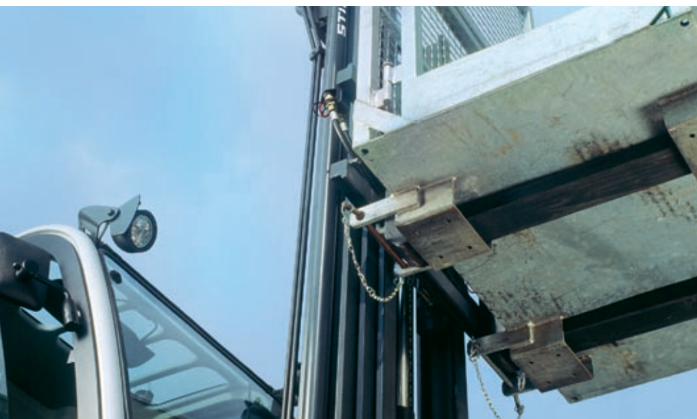
门架和链条转向滚轮能够确保升降重物的精准移动
