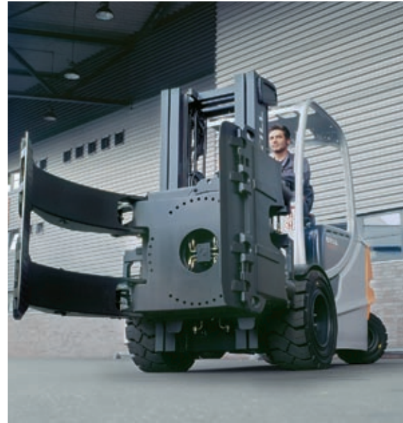
INA回转轴承可用于叉车属具，比如纸卷旋转架。
