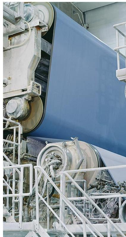
造纸生产线要求无故障运转，理想的运行周期为1年365天。根据所使用的纸机，在一分钟之内可以生产出由纤维浆或废纸为原料的2000米长、10米宽的纸张。这对烘缸、辊以及滚动轴承都是非常严峻的考
