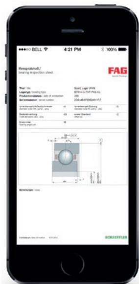
直接通过APP打开主轴轴承 B7014的检验单。
