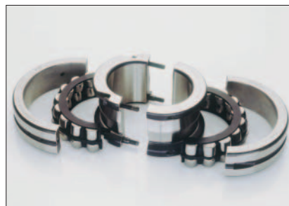
4: 具有玻璃纤维加固聚酰胺或黄铜制成的剖分式实体保持架的剖分式调心滚子轴承，带集成锁紧环
