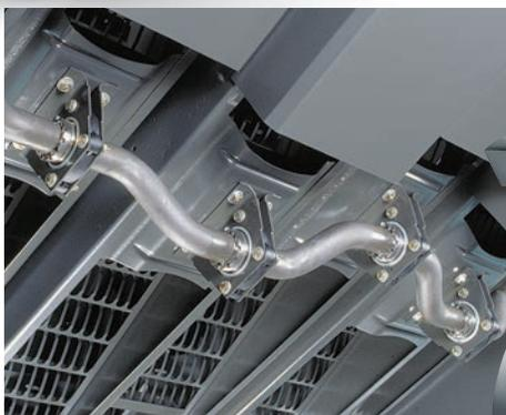
高侧倾刚性、结构更紧凑：应用于联合收割机逐稿器振动曲轴的INA四点接触球轴承
