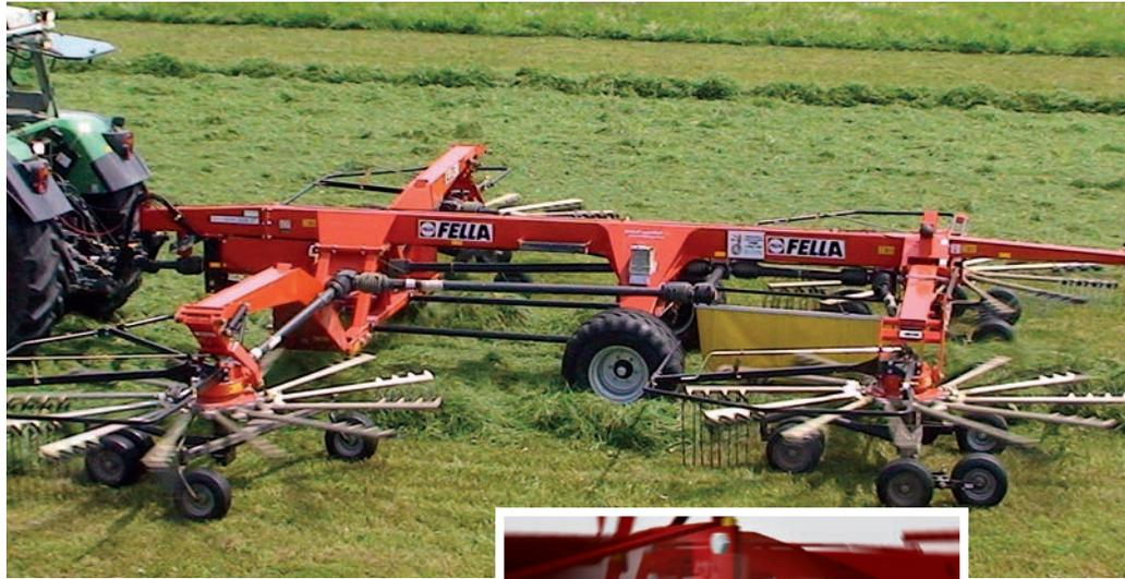
用于弹齿回转臂的INA滚轮轴承确保搂草机运转可靠和使用寿命更长
