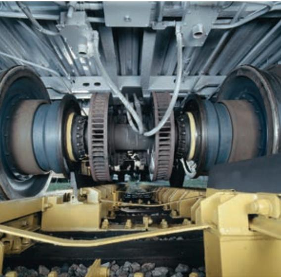
欧洲和亚洲存在的五种不同轨距仍在影响着跨国境的客货运输。一种自动轨距调节系统应运而生。这种轨距调节装置安装在边界站点上，它可以很快捷的将车辆（装有可调轨距系统）的轨距调整到指定大小。
