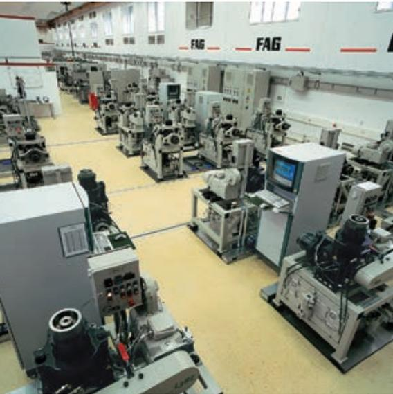
完全组装好的轴承、单个零部件和材料的性能均可在施魏因福特工厂约7000 m<sup>2</sup>的实验室进行测试。通过自主研发的100多种不同类型的试验台架，每年大约可完成700个不同设计不同尺寸的轴承测试。轴承在极限条件下的可靠性通过铁路轴承试验台架进行测试。依据DIN EN 12082标准，使用特殊的轴箱轴承试验台架对轴承进行测试。试验台架能模拟高达550km/h的运行速度和180km/h的风速。这些试验大大延长了轴承的使用寿命和维修周期。如今，根据运行条件，120万公里的轴承检修周期已经成为干线列车标准。
