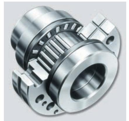
固定端轴承不仅能承受很高的径向力也能承受双向的轴向力。轴承需要用INA精密锁紧螺母在轴向加载，以确保轴承在无游隙状态下工作。滚针/推力圆柱滚子轴承通过外圈补脂，可以采用一个密封架组件进行密封。
