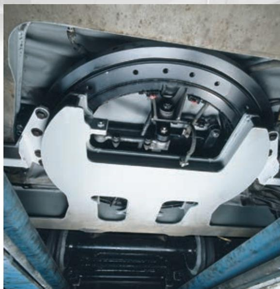
间的加速度。在低地板车辆中，还需承载上部车体重量(车厢)。
