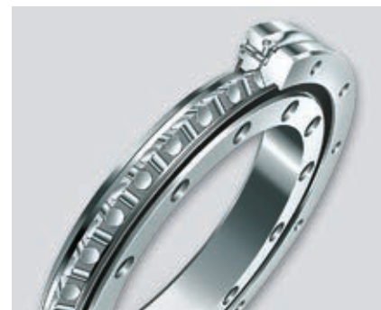
节省轴承空间：INA交叉滚子轴承-XSU可以承受径向、轴向负载、倾覆力矩及联合载荷
