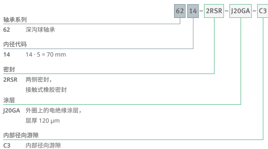
图20 外圈带绝缘涂层的深沟球轴承
