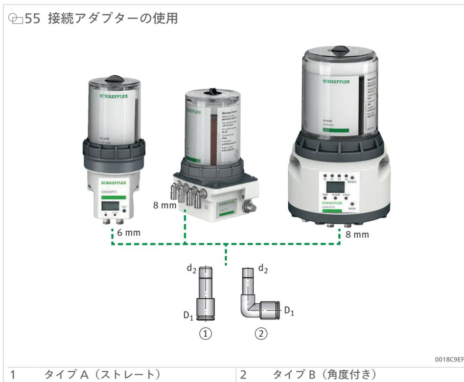
接続アダプターの外径  $d_2$  側を潤滑装置の吐出口に挿入し、止まる位置まで押し込みます。その後、潤滑配管を接続アダプターの内径  $D_1$  側に挿入します。
