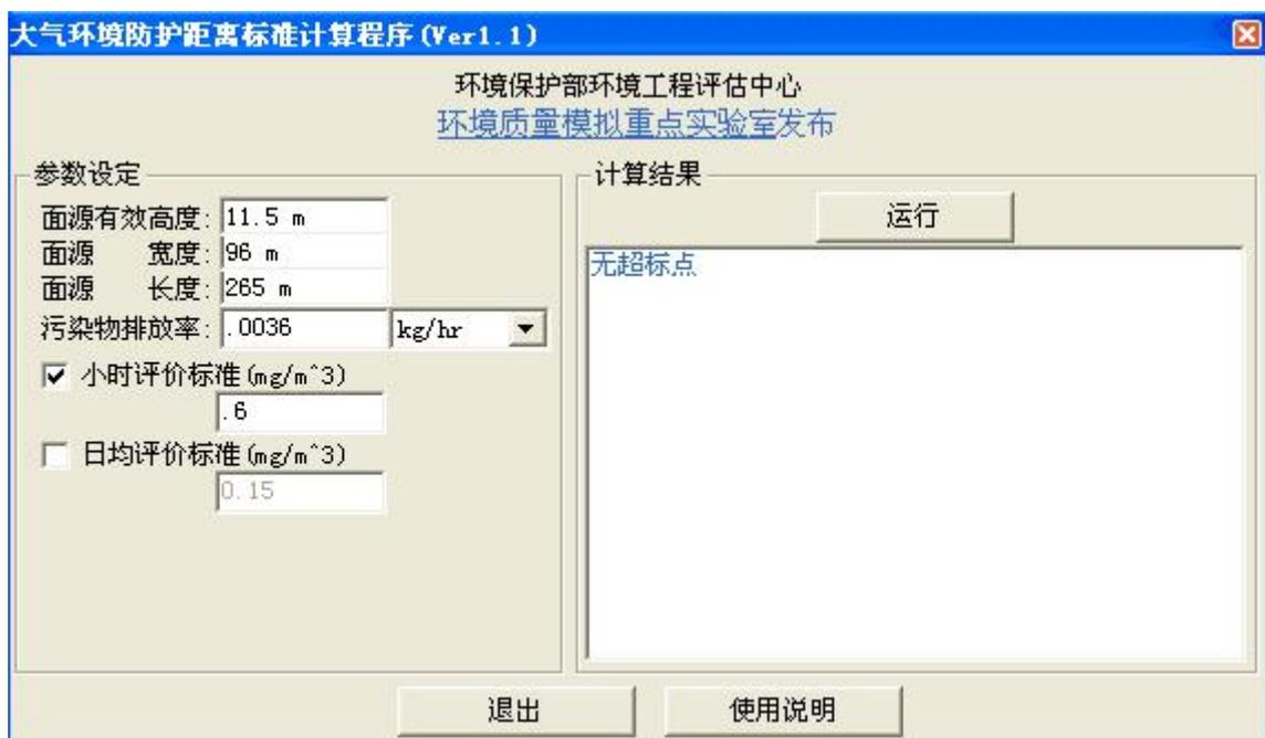
图 7-1 项目无组织排放的 VOCs 大气环境保护距离计算情况图
