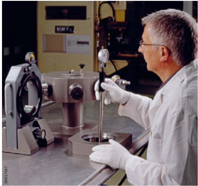
图 2 测量外圈的滚道直径
