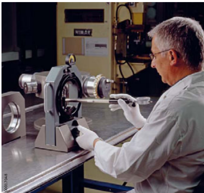
图3 将测得的直径传递给包络圆量规
