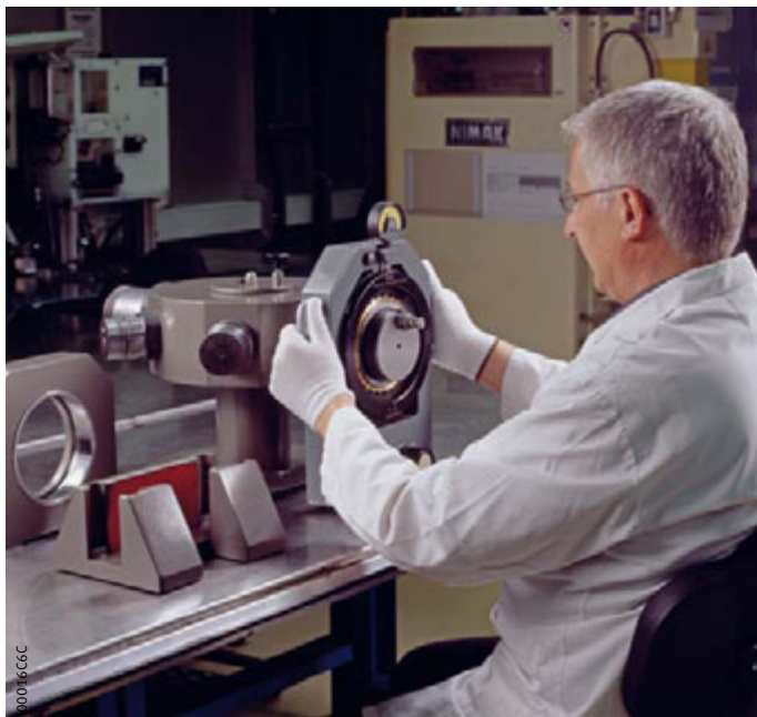
图4 包络圆量规的位置调整
