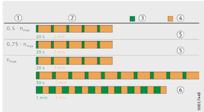
图 4 开式和密封式的主轴轴承匀脂工艺
